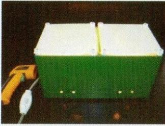
ガイナの遮熱、断熱効果を体感できる実験機。付属する放射温度計を使用することで温度での比較を行うこともできます。
