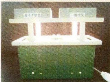
断熱実験機の上部にコンクリート実験機キットをセットし、ライトを照射することで、ガイナの遮熱効果を確認できます。
